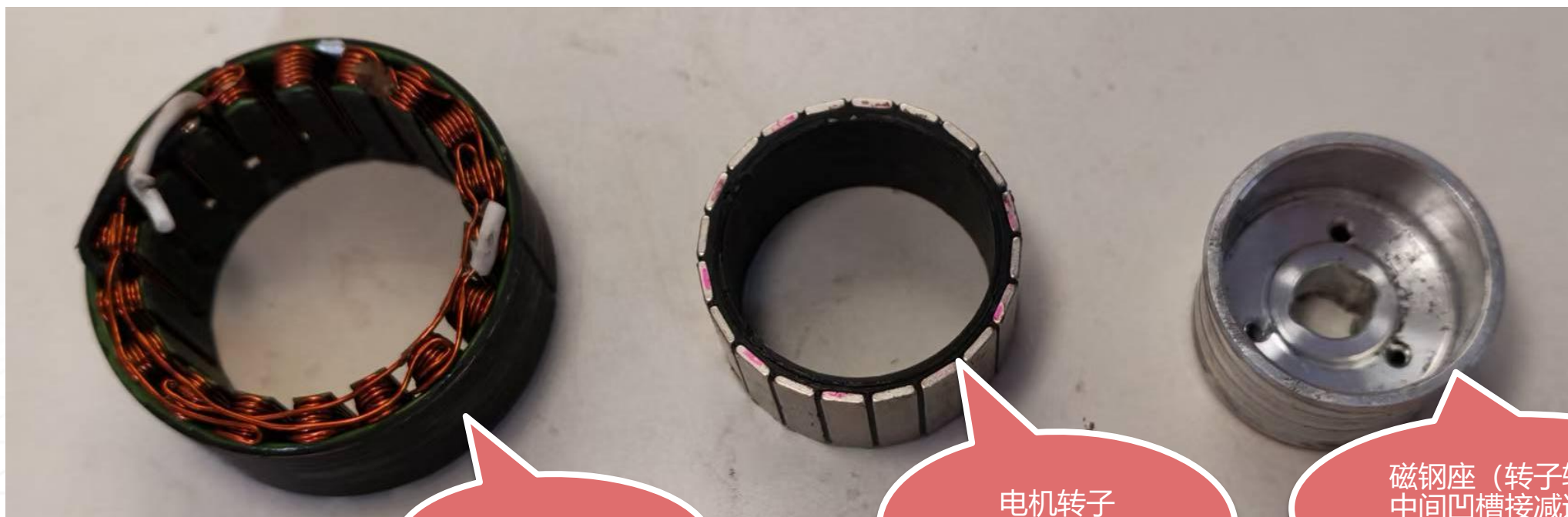
图表14：小关节局部零部件图---电机
