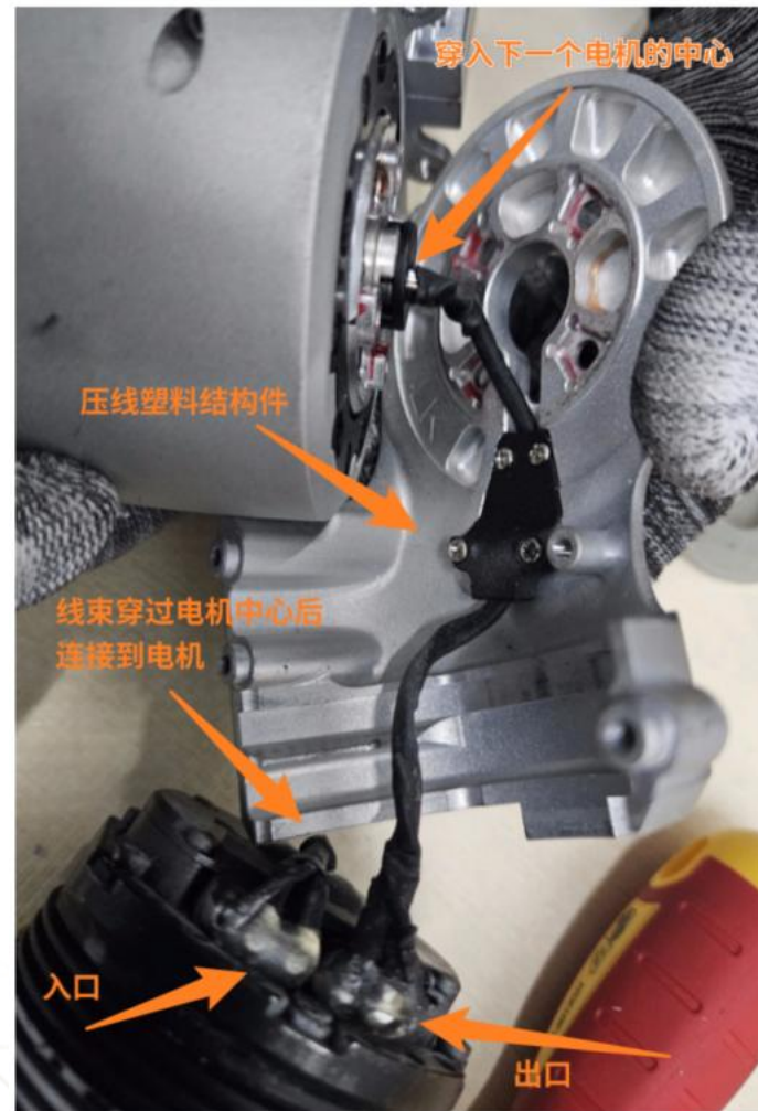
图表29：关节间线束连接示意图
