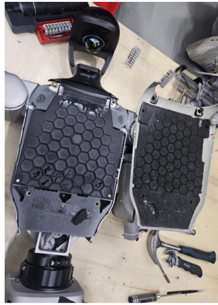
图表39：躯干大面积采用工程塑料
