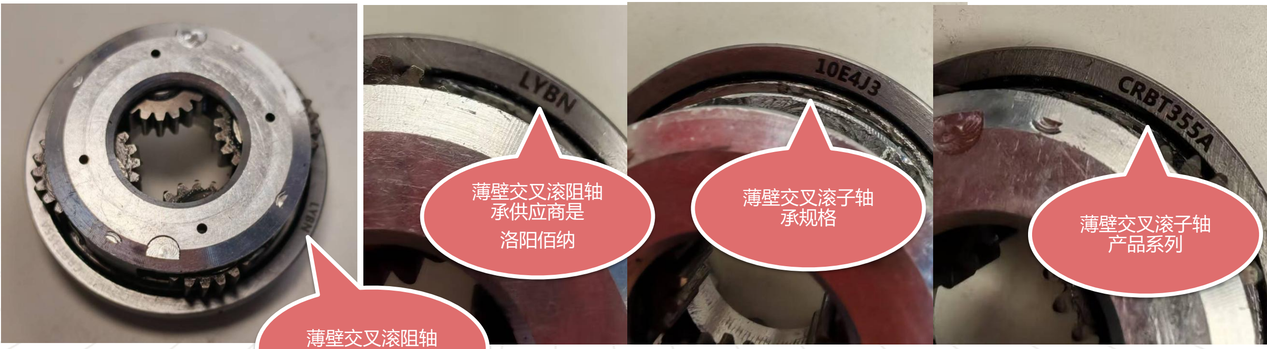
图表16：小关节局部零部件图---薄壁交叉滚子轴承
