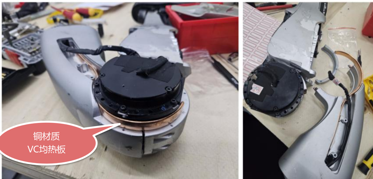
图表35：膝部关节采用VC均热板散热方案
