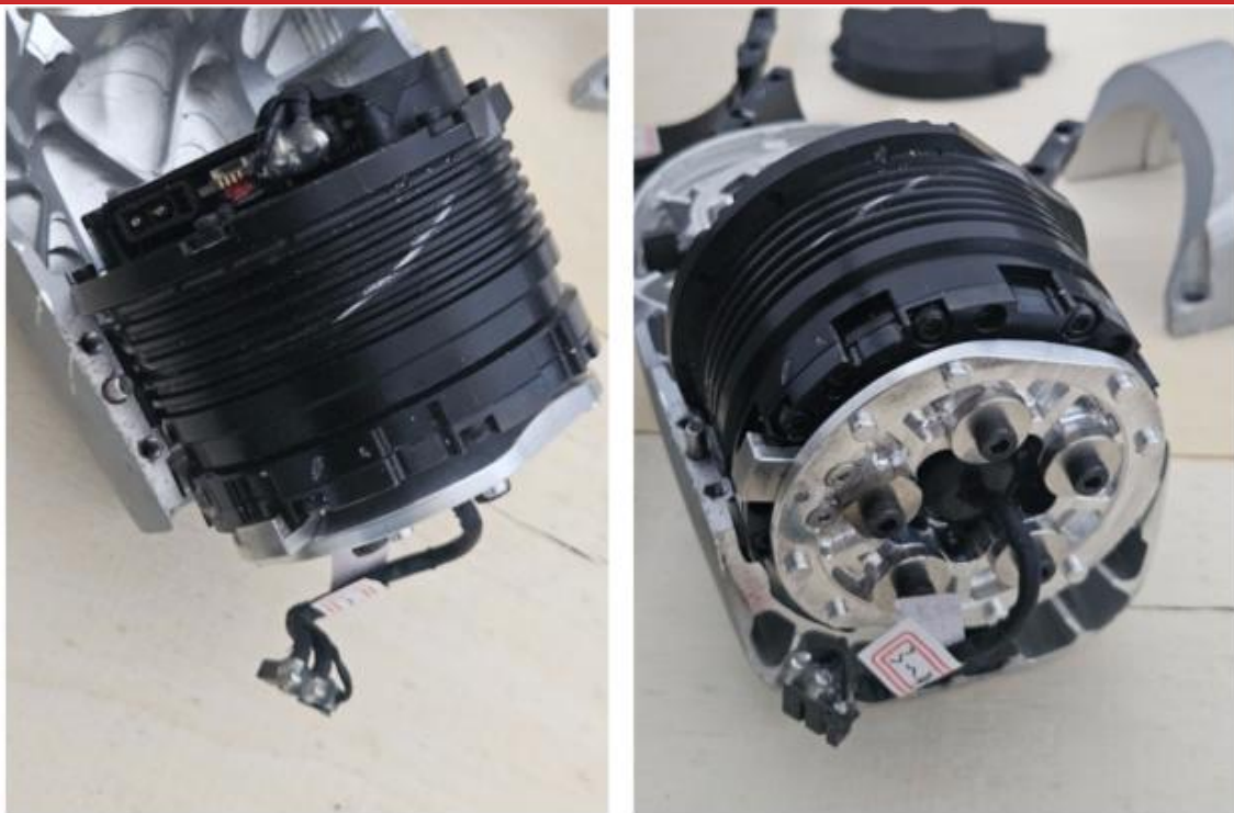
图表28：关节表面线束示意图
