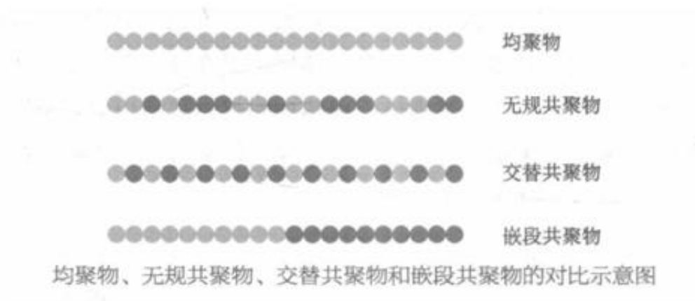
均聚物、无规共聚物、交替共聚物和嵌段共聚物的对比示意图
