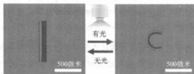
含有聚 N- 异丙基丙烯酰胺（图中深色部分）的双层水凝胶变形原理
