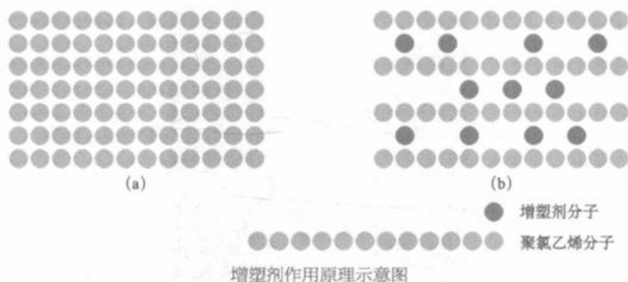
(a) 表示普通的聚氯乙烯中，聚氯乙烯分子之间相互作用较强，使得材料过于硬脆； (b) 表示增塑剂分子分散到聚氯乙烯分子之间后，削弱了聚氯乙烯分子之间的相互作用，使得材料塑性增强
