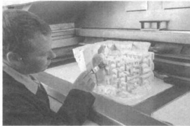
在 3D 打印过程中，没有被黏合或者加热熔融的粉末可以对正在制造的结构起到支撑作用；制造完成后，这些粉末很容易被除去
