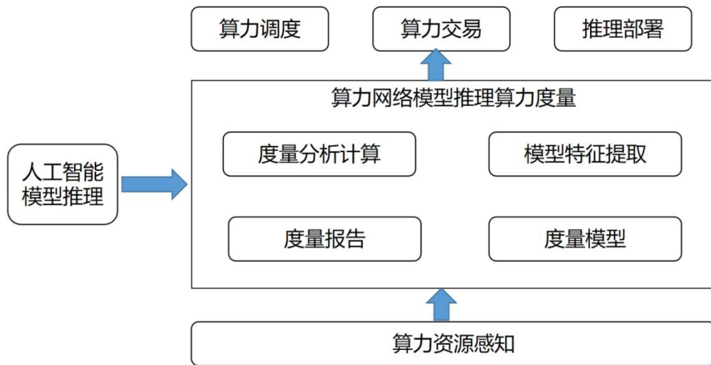
图 3 算力网络人工智能模型推理功能示意图
